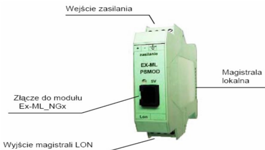
Rys. 10.4. Opis złączy na module Ex-ML_PSxx
