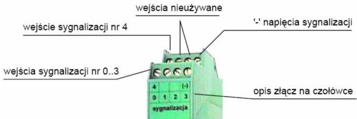
Rys. 2. Złącza sygnalizacji modułu Ex-ML_CMB
