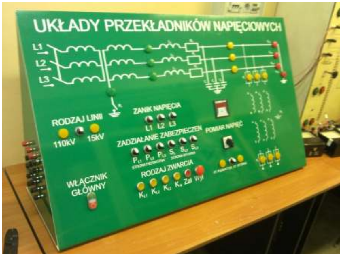
Rys. 1. Widok płyty czołowej stanowiska do badania układów przekładników napięciowych.
