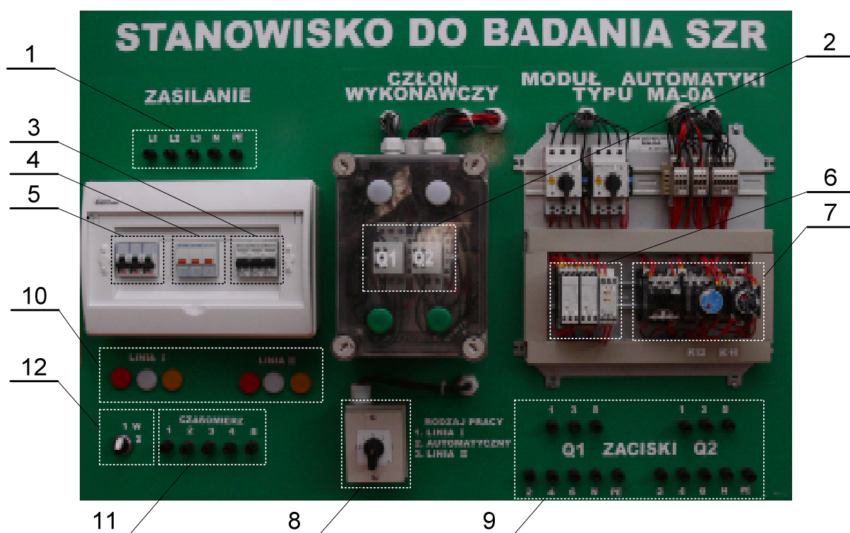
Rys. 2. Stanowisko do badania SZR: 1 – Zaciski zasilania; 2 – Styczniki Q1, Q2; 3 – Linia II rezerwowa; 4 – Lampki sygnalizacyjne; 5 – Linia I podstawowa; 6 – Układ logiczny; 7 – Przełączniki czasowe K11 i K12; 8 – Przełącznik rodzaju pracy; 9 – Zaciski styczników Q1 i Q2; 10 – Lampki sygnalizacyjne linii I i II; 11 – Zaciski czasomierza; 12 - Przełącznik W
