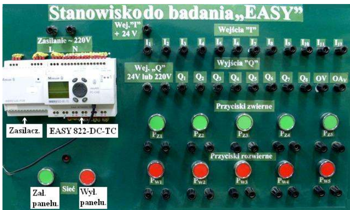
Rys. 2. Widok panelu sterującego bez wykonanych połączeń
