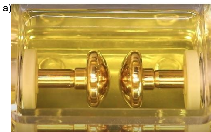
Rysunek 1. Analizator napięcia przebicia oleju BA75/100 wykorzystany do badania napięcia przebicia oleju izolacyjnego w zależności od odległości międzyelektrodowej.
