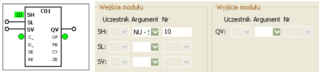
Rys. 14. Widok schematu blokowego modułu licznika oraz jego wejść i wyjść
