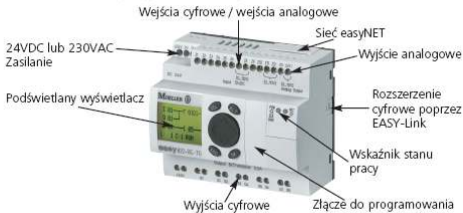
Rys. 1. Widok przekaźnika EASY z wyszczególnieniem jego charakterystycznych cech
