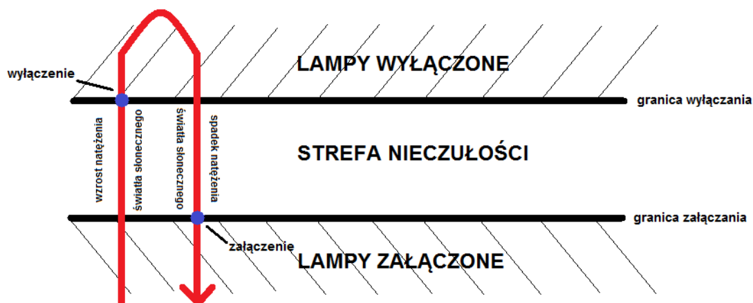
Rys. 6.1. Graficzna ilustracja sterowania oświetleniem z wykorzystaniem histerezy przełączania
