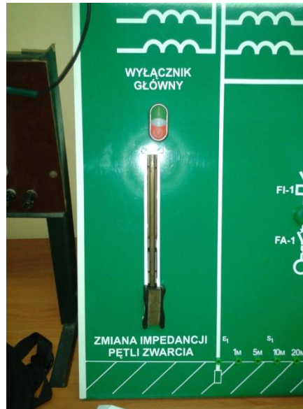
Rys. 3. Wyłącznik główny oraz suwak do zmiany impedancji pętli zwarcia
