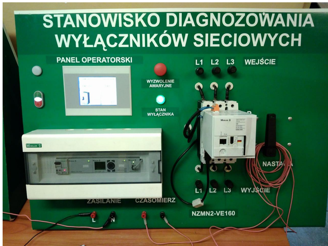
Rys. 1. Elementy stanowiska laboratoryjnego
