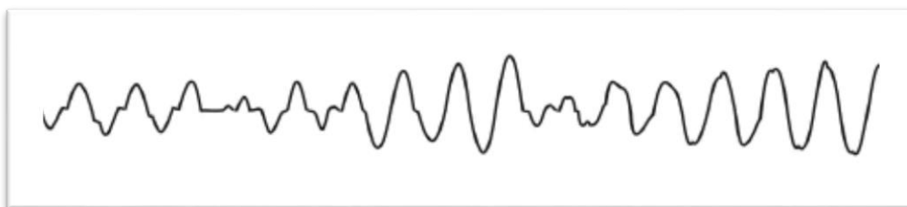
Rys. 3.5 Przykładowy przebieg czasowy prądu pieca w pierwszych minutach roztopienia [5]
